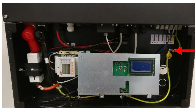
Figura 38 – Vite per il collegamento della massa del sistema di accumulo all'impianto di terra dell'utenza
