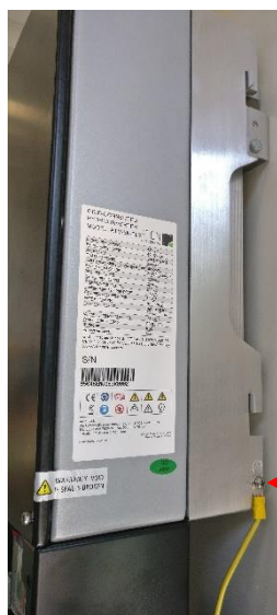
Figura 39 – Collegamento tra il nodo di terra della macchina e la massa del dissipatore
