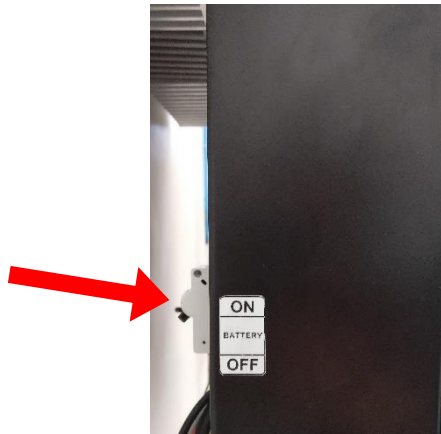
Figura 35 - Posizione in cui si deve trovare l'interruttore sul retro dell'inverter
