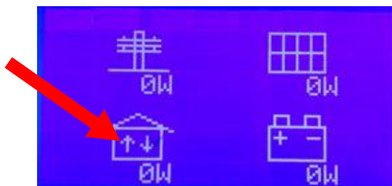
Figura 80 - Verifica della comunicazione attiva con il portale Aton
